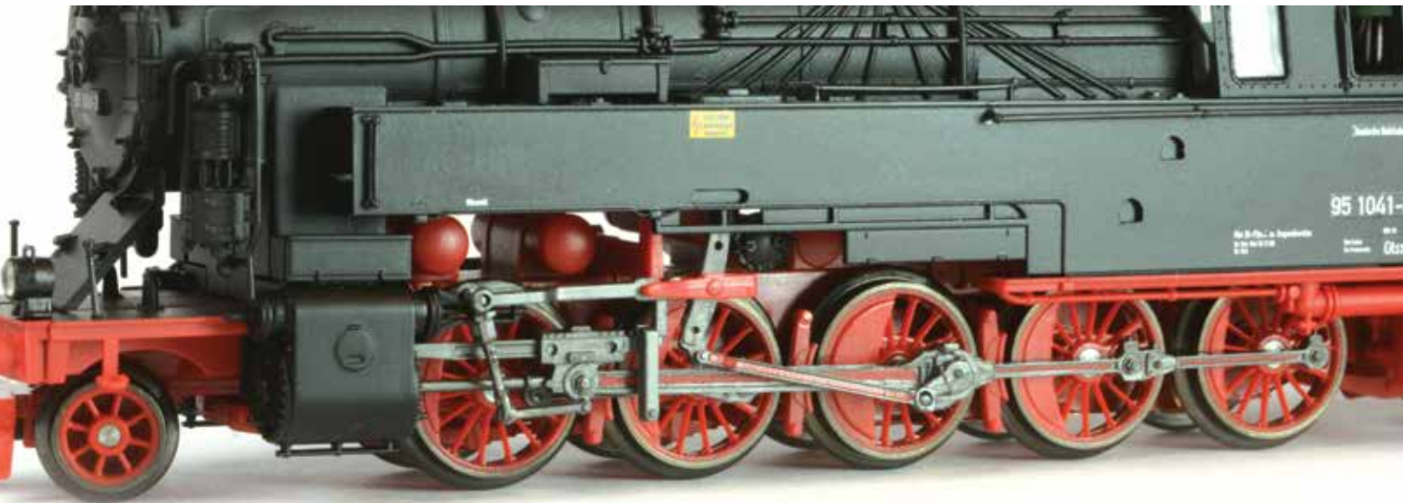
▲ A kis kerékátmérő teszi alkalmassá a mozdonyt nehéz terhek vontatására. Bár csak modellben is így lenne...
