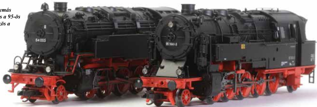
▲ A kis kerékátmérő teszi alkalmassá a mozdonyt nehéz terhek vontatására. Bár csak modellben is így lenne...
