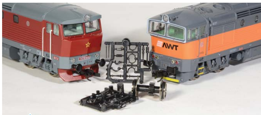
▲ Mindkét mozdonyhoz egységes kiegészítők járnak: megannyi műanyag szerelvény és a tapadógyűrűs hajtott kerék
