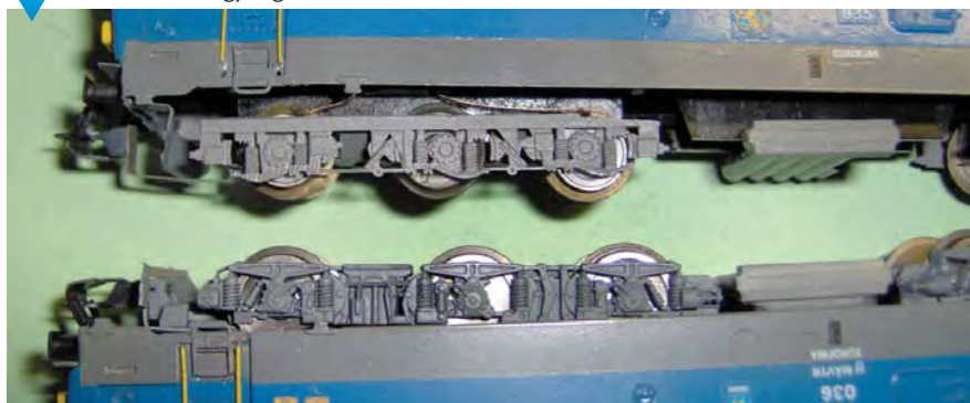
Az eredeti tengelytávu forgóváz a kevésbé látványos, maratott maszkkal, és a 151-es hasonló részegysége (fotó: Jakó Attila)
